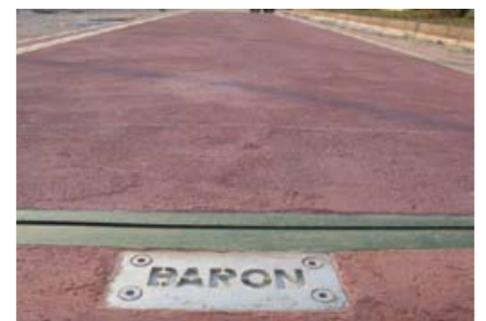
Pesa a ponte connessa a sistema di gestione con controllo merci con software IN/OUT e vari accessori
