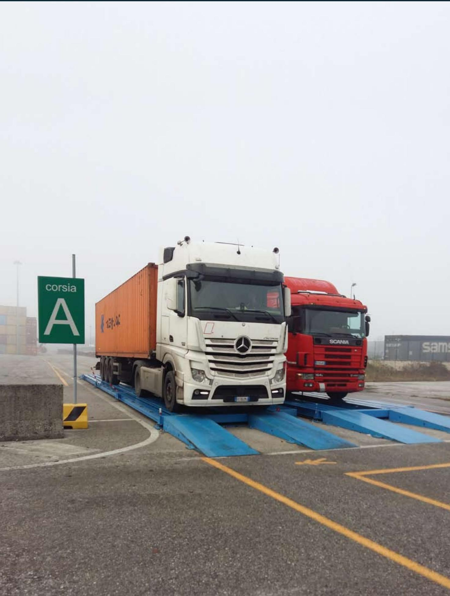
La pesa a ponte **mod. FTE** è stata progettata basandosi sui criteri di robustezza, ma anche facilità di montaggio e trasportabilità. È composta da due corsie formate da travi HEA sotto la carreggiata e centralmente viene lasciata libera garantendo circolo d'aria e pulizia. Le celle di carico, in acciaio INOX con protezione IP68/69, sono posizionate all'interno di traverse situate nella giunzione dei moduli.
