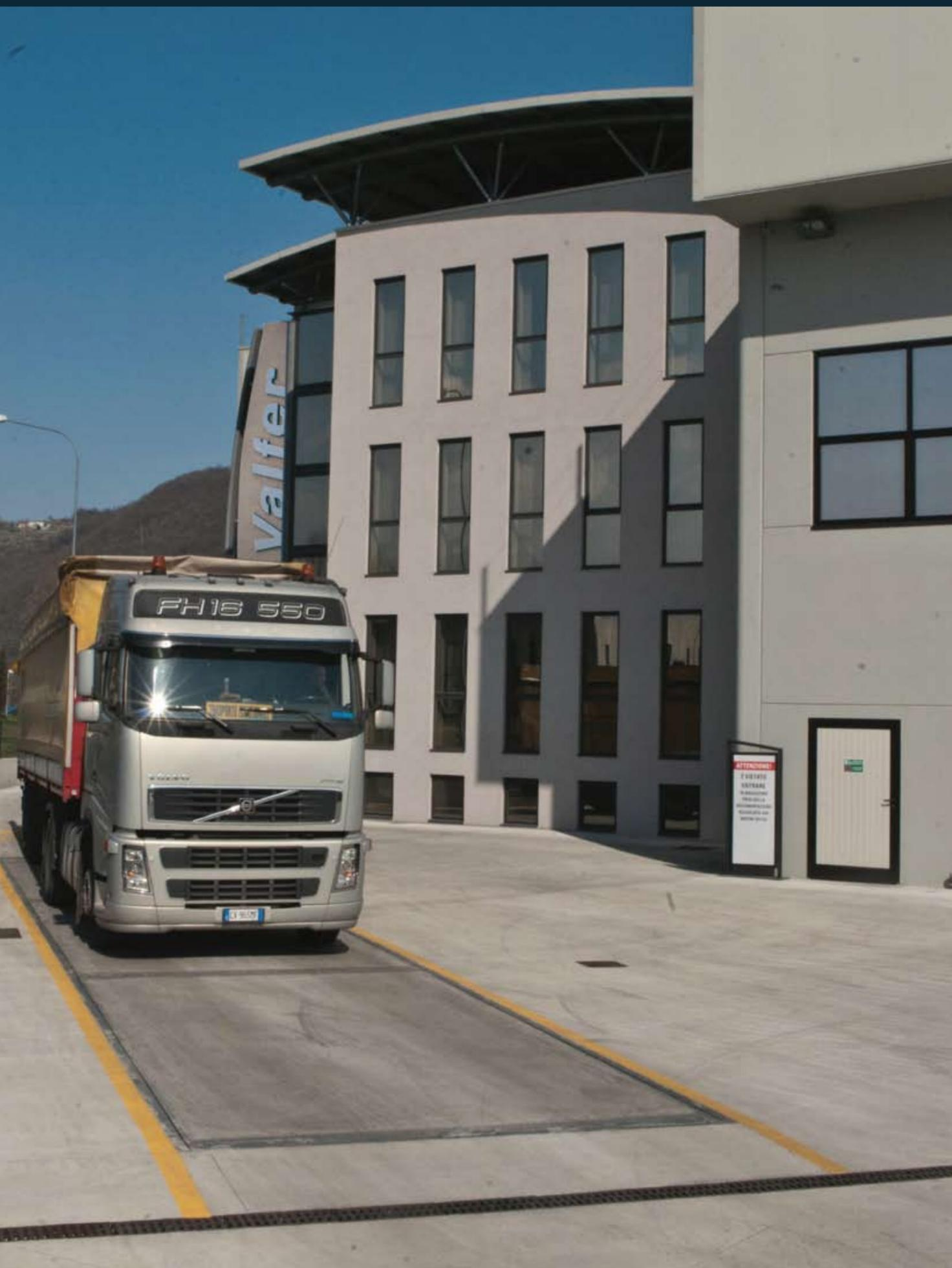
La pesa a ponte **mod. MCAZ** è realizzata con moduli indistruttibili d'acciaio e calcestruzzo, garantendo la più alta affidabilità e resistenza nel tempo. I moduli sono collegati tra loro tramite bulloneria, lasciando nella giunzione lo spazio per le celle di carico in acciaio INOX con protezione IP68/69. Successivamente i moduli vengono lavorati e riempiti con un getto di calcestruzzo di spessore adeguato. Tutta la carpenteria è zincata a caldo secondo la norma UNI EN ISO 1461: 2009.
